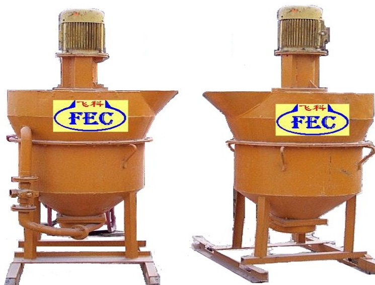
图 7.5-6 ZJ-400 型立式高速耐磨制浆搅拌机
