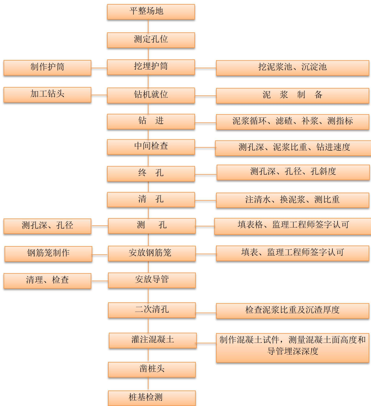
图 7.5-1 混凝土灌注桩施工工艺流程图
