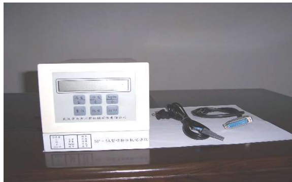
图 7.5-7 SP-5A 型深层搅拌记录仪
